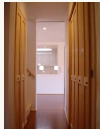
■1階廊下 暗くなりがちな廊下も両側を開口することで、通風・採光性を高めています。
